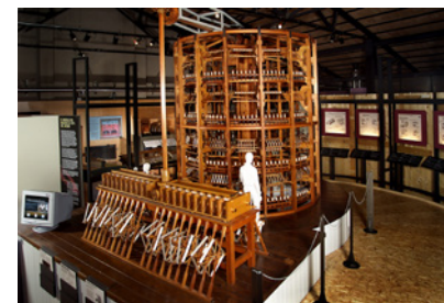
Modello funzionante in scala 1:2 di mulino da seta alla bolognese Museo del Patrimonio Industriale
