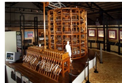
Modello funzionante in scala 1:2 di mulino da seta alla bolognese
